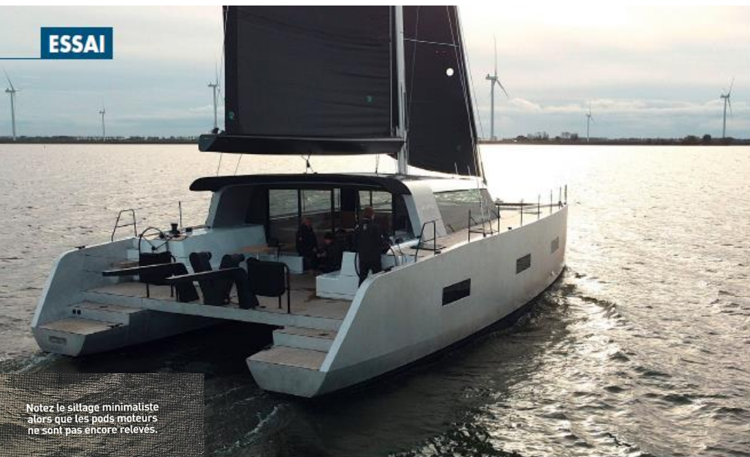
Fluidité du design : le rail de grand-voile est inséré dans le rouf et prolongé par un bimini textile sur structure alu.
