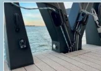
Il n'y a rien pour arrêter la chute d'objets ou de bouts à l'arrière du cockpit.
