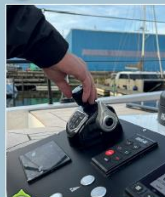
Joystick, boutons de winches électriques : un poste de barre futuriste !
