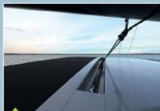
Fluidité du design : le rail de grand-voile est inséré dans le rouf et prolongé par un bimini textile sur structure alu.
